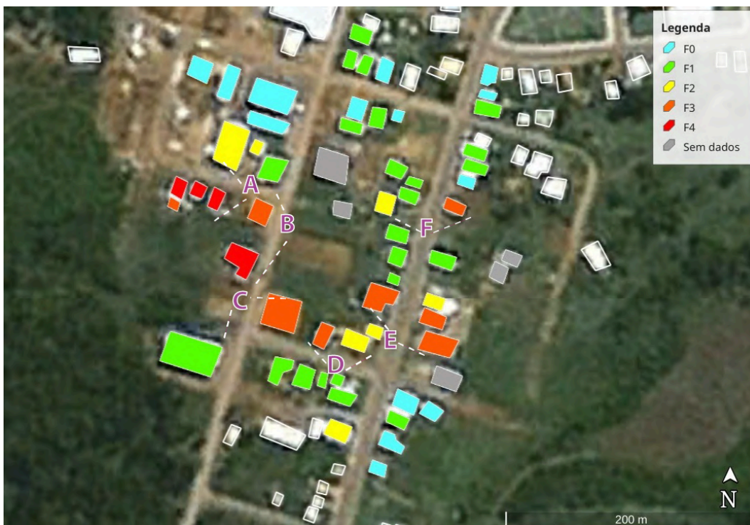
Figura 11 - Mapeamento da intensidade de danos por construção considerando a escala Fujita sobre uma imagem satelital obtida em 2004 e disponível no software Google Earth. A legenda no canto superior direito indica a correspondência de cores com a respectiva intensidade dos danos entre F0 e F4. As letras A,B,C,D,E e F correspondem às visadas dos danos apresentados ao longo deste documento.
